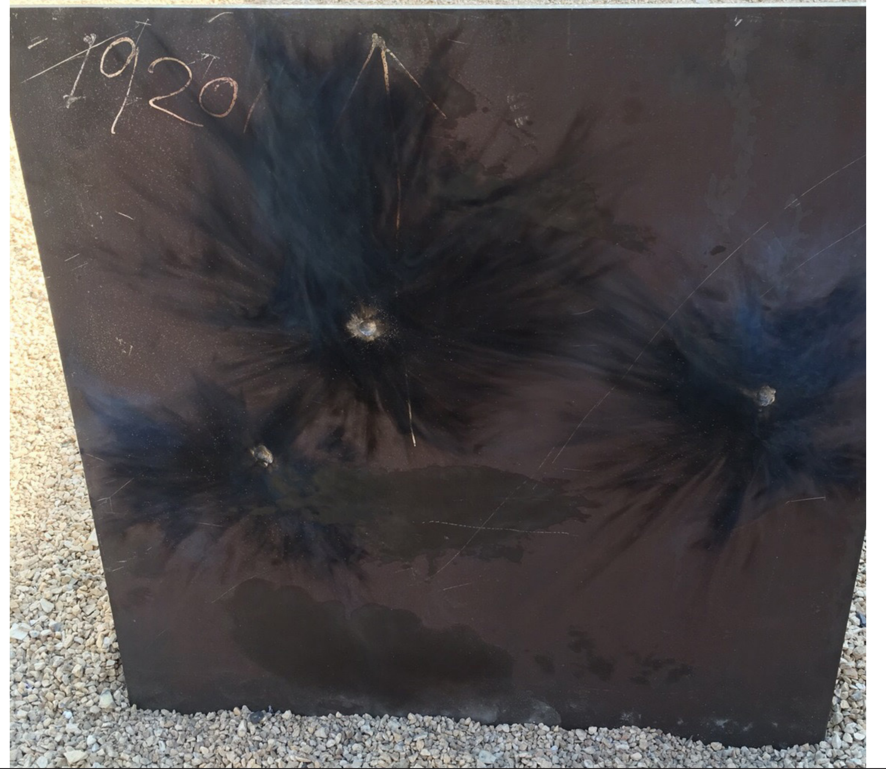
Test de balle réel pour l'acier de blindage de classe de protection B7
